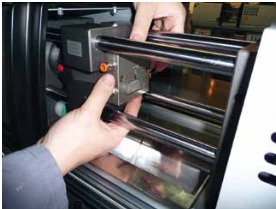
Фото 1. Смена литевых форм без применения внутризаводского крана позволяет резко уменьшить затраты времени на эту операцию (фото: babyplast)
