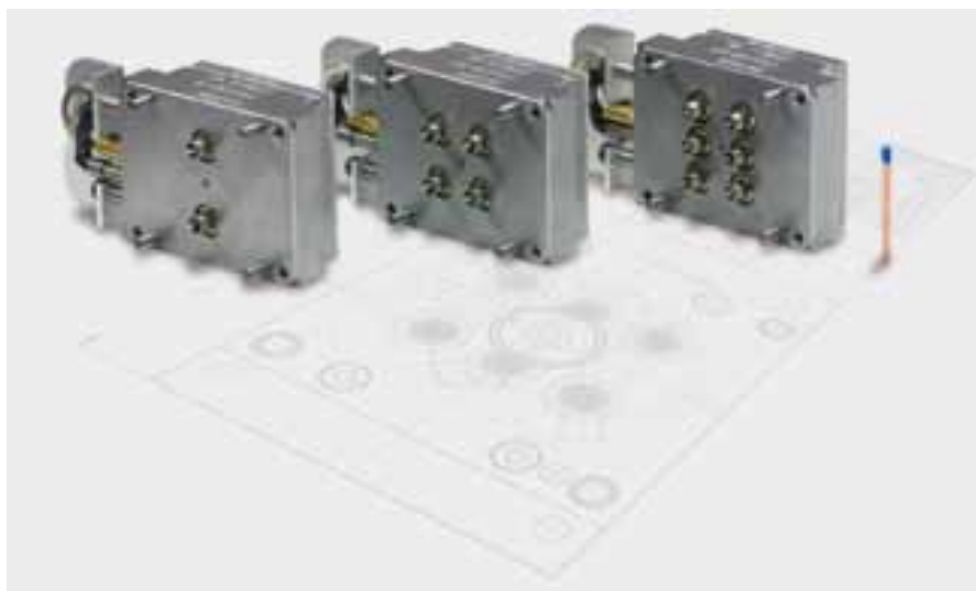
Фото 3. ГКС для двух-, четырех- и шестигнездных форм. При смене литейной формы ГКС остается на машине: заменяется только формообразующая вставка (фото: Ewikon)
