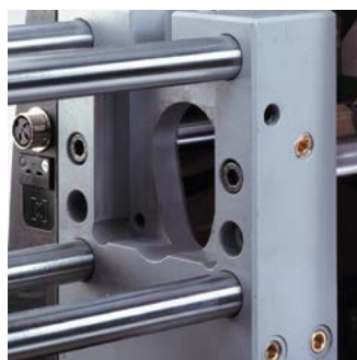
Вид на неподвижную плиту
