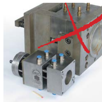
Различие между пресс-формой Babyplast (передний план) и традиционной (задний план) для производства одних и тех же деталей с одинаковым количеством гнезд
