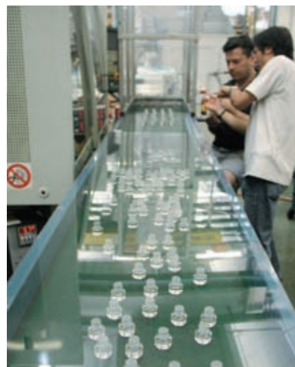
Фото 2. Поставленное на поток серийное производство двухкомпонентных пробок – по 8 шт. каждые 90 с
