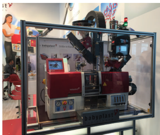
Фото 1. Новая машина Babyplast 10/10 в комплекте с автономным узлом впрыска UAI Babyplast и сушилкой материала, совмещенной с автозагрузчиком и дозатором суперконцентрата (фото: «ВЛ-ПЛАСТ»)
