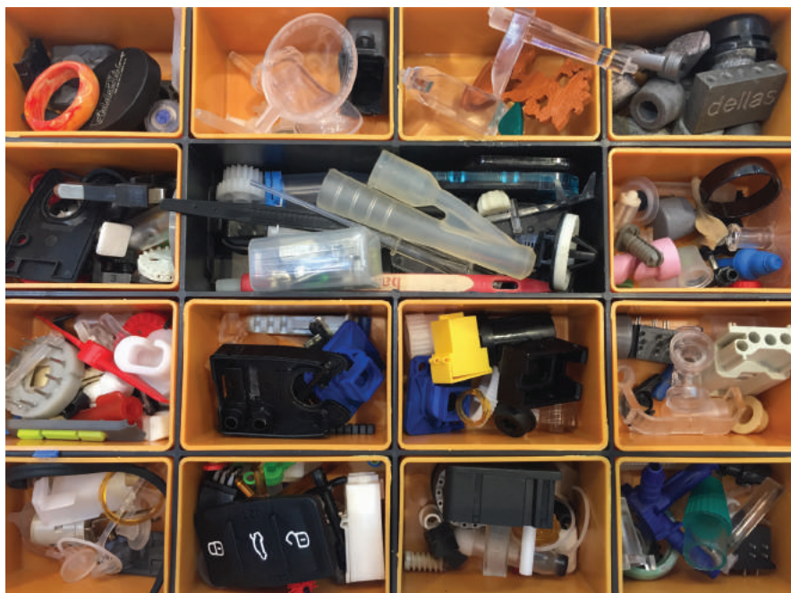
Фото 4. Примеры различных микроизделий из различных полимерных материалов, изготовленных на машинах Babyplast (фото: «ВЛ-ПЛАСТ»)
