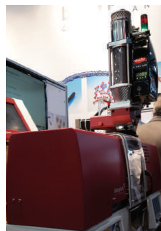
Фото 2. Литьевая машина Babyplast 610P в горизонтальном исполнении в комплекте с сушилкой и загрузчиком гранулята
