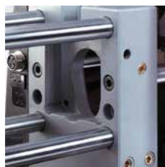
Вид на неподвижную плиту
