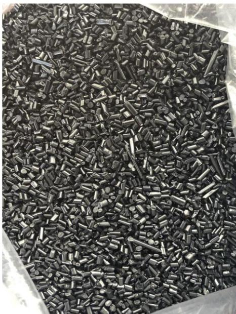
Образец полимерного материала был получен в виде небольших гранул чёрного цвета (примерный размер: диаметр-2 мм, длина - 5-8 мм.).
