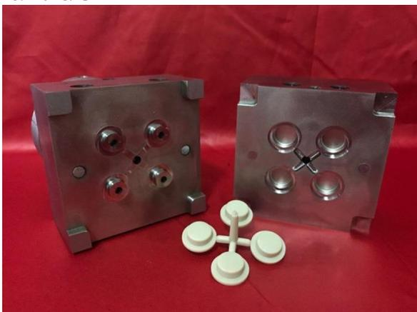
4х местная холодноканальная прессформа для деталей Толкатель с отливкой из материала ТЭП
