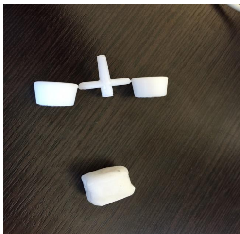
Отливки деталей из материала Поликапролактон (Polycaprolactone, PCL)
