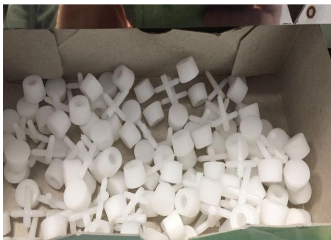
Отливки деталей из материала Поликапролактон (Polycaprolactone, PCL)
