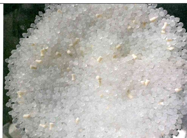
Смесь гранулированных микросфер 930MB120 с ПЭВД 18103-035
