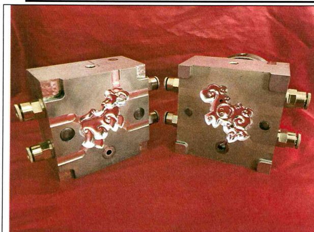
Одноместная литевая пресс-форма для ТПА Babyplast 6/10P
