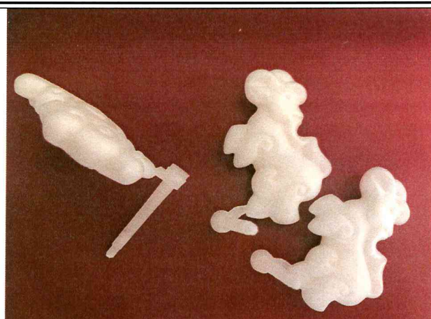
Отливки деталей из ПЭВД 18103-035 с добавлением микросфер 930MB120
