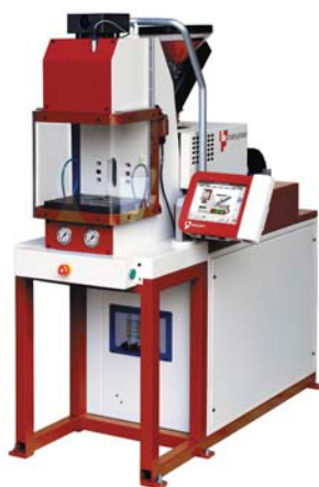
Вертикальные термопластавтоматы с неподвижным, слайдерным или поворотным столом
