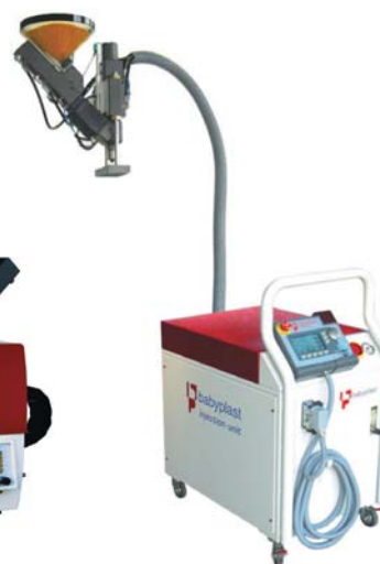
Автономные узлы впрыска для производства многокомпонентных деталей. Совместимы с любым ТПА
